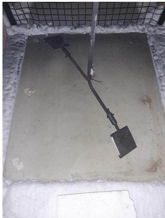
*Photo de la face exposée au feu avant et après essai de la dalle 2024-57-D2*
