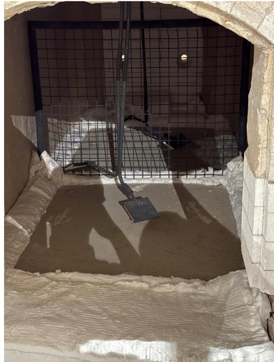
*Photo de la face exposée au feu avant et après essai de la dalle 2024-57-D1*
